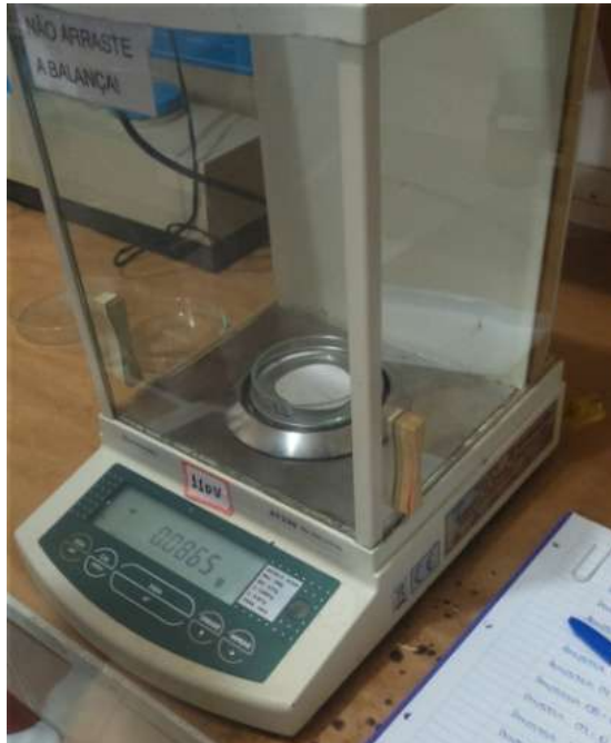
Figura 32 - Membranas na balança de precisão sendo pesadas e identificadas.
