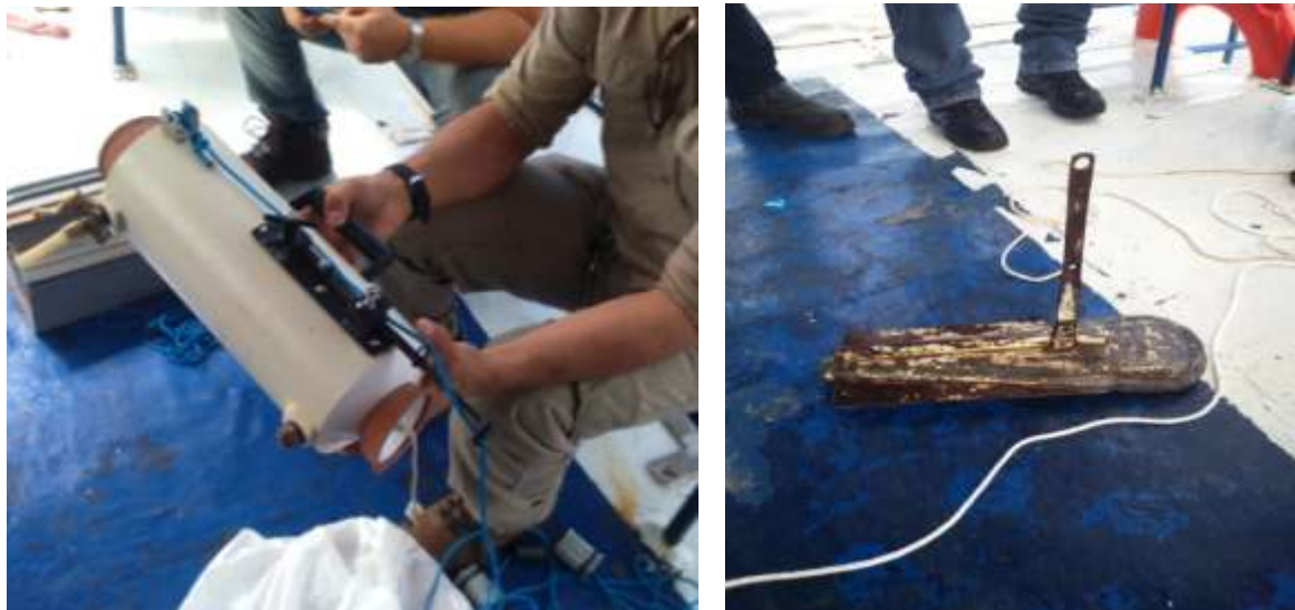
Figura 22 – Garrafa de Van Dorn e Lastro utilizado nas medições.
