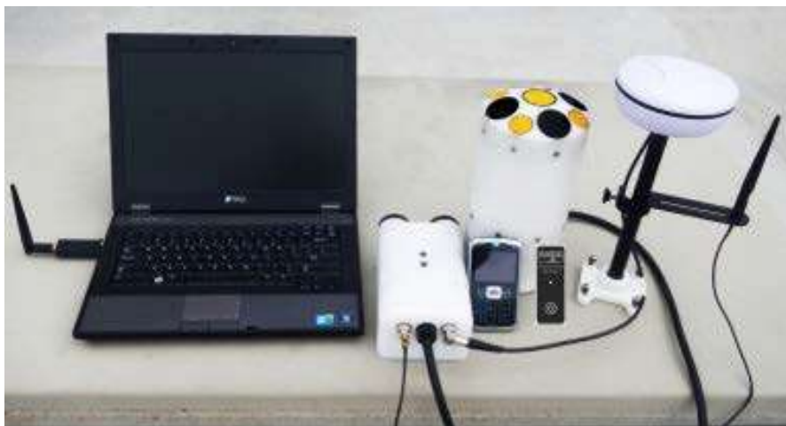
Figura 16 - Laptop, Smartphone, ADP da Soltek modelo M9, módulo de alimentação e antena DGPS.
