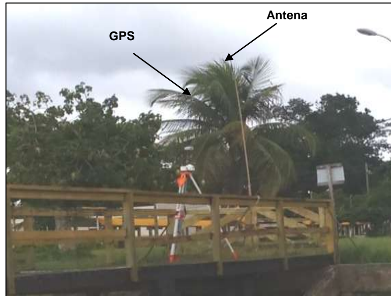
Figura 26 – Equipamento RTK instalado sobre o trapiche da UFPA.
