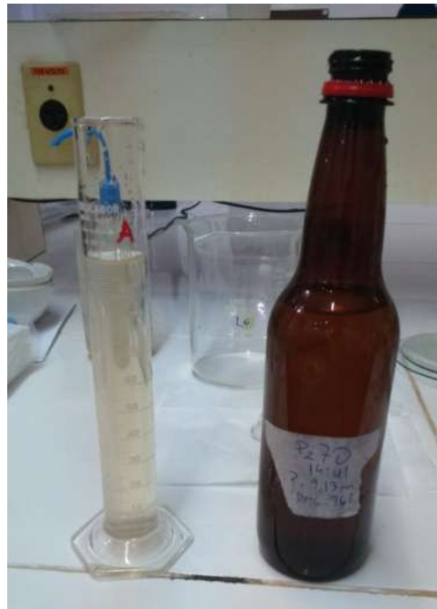
Figura 31 - Proveta com 100 ml de amostra e garrafa plástica utilizada na pesquisa.
