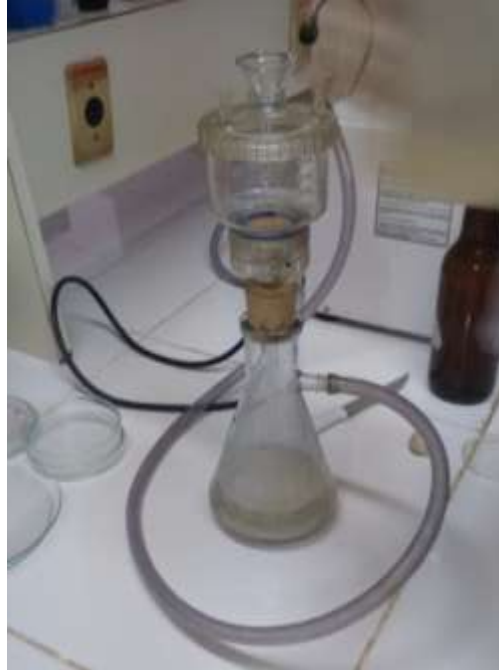
Figura 30 - Cadinho de Gooch ligado em uma bomba de vácuo utilizado nos ensaios em laboratório.
